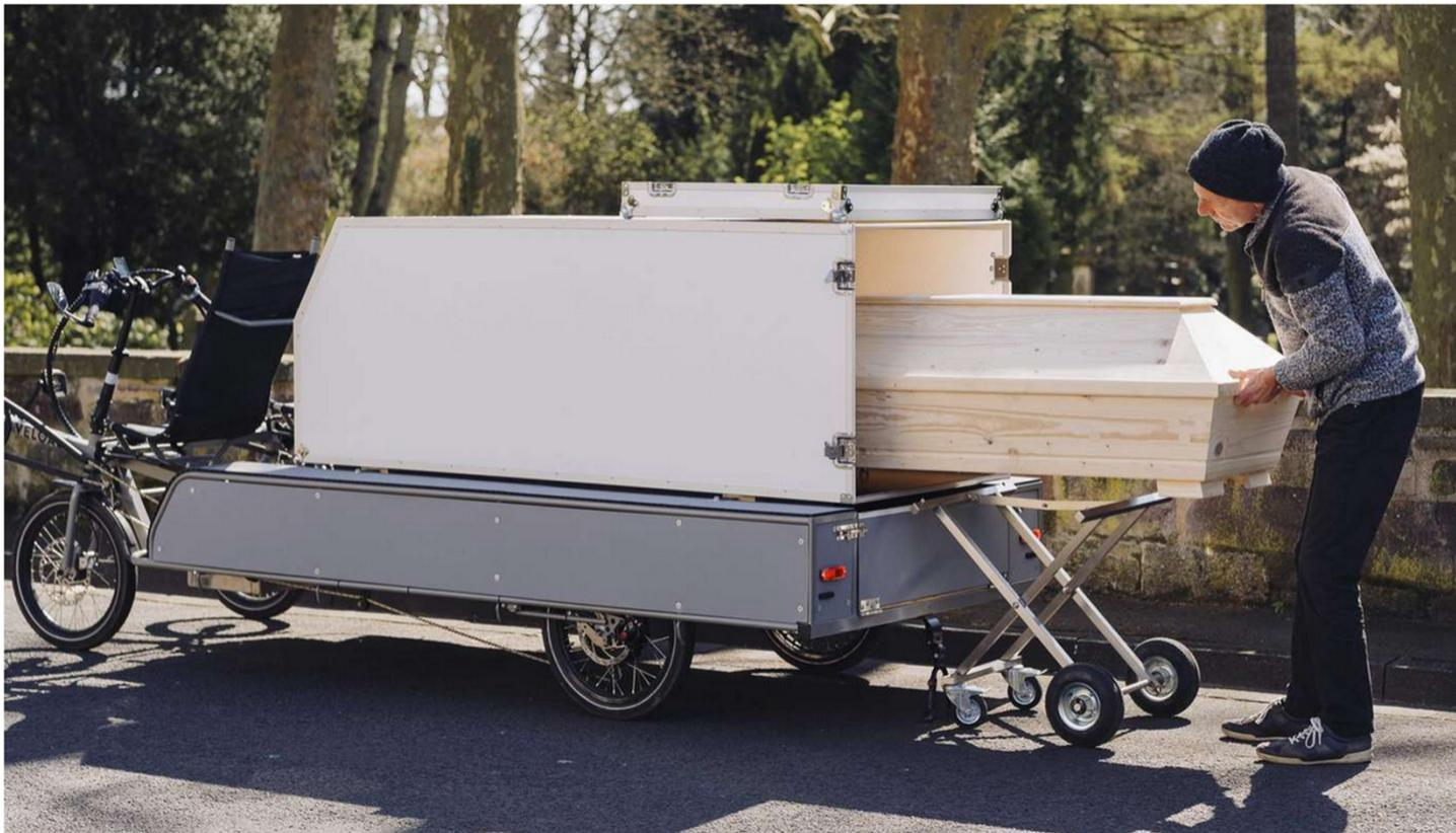
25 Stundenkilometer schnell, 3,30 Meter lang und bis zu 50 Kilometer Reichweite: Der Kasseler Bestatter Jürgen Dahlfeld mit seinem Lastenrad des Kasseler Start-ups Veload auf dem Hauptfriedhof. © Fiona Körner
